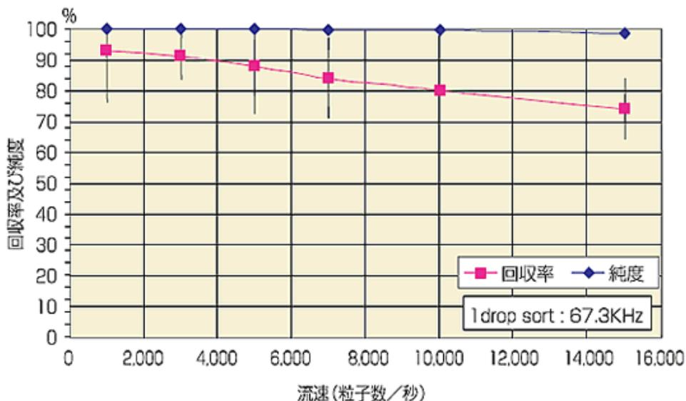
標準ビーズをソートした時の回収率および純度
