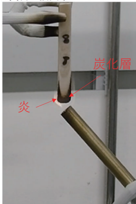
図3 厚さ 4mm(e) の短冊形射出成形品の UL94 垂直試験の様子
