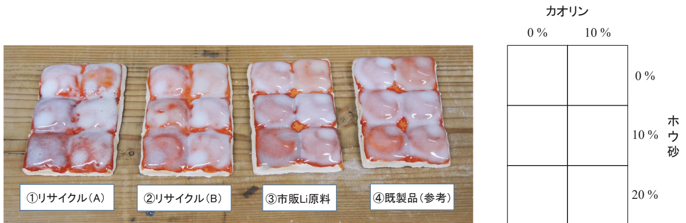
図8 焼成後の無鉛低融点フリットのテストピース写真 (各フリットに、カオリン／ホウ砂を右図に対応する分量添加して焼成)
