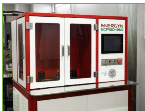
セラミックスや粉末冶金の高度化に有効な「小型 CIP（冷間等方圧プレス）装置」
