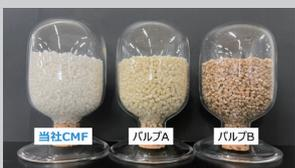
PP マスターバッチ外観 | <ul style="list-style-type: none"> <li>・ユーザーニーズに合わせた繊維調整、小ロット対応が可能</li> <li>・トイレットペーパー損紙から生まれたりサイクル原料</li> <li>・製紙技術を活用した製法で生産効率が大幅に向上し、低コストを実現</li> <li>・幅広い繊維幅分布とフィブリル化促進による強度向上効果</li> </ul> |
