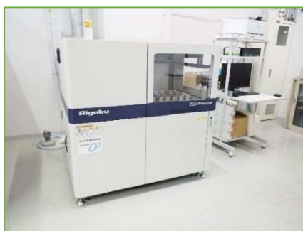
新材料・新製品の研究開発や品質向上等の改善のに向けた活用ができる「蛍光X線分析装置」
