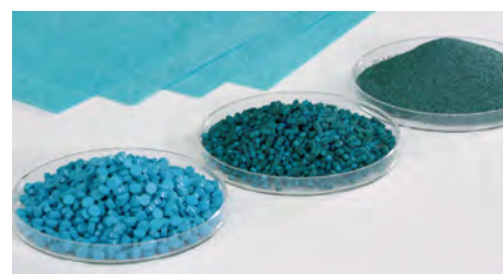
上:シート品、下:左から打錠成形品、押出成形品、造粒品
