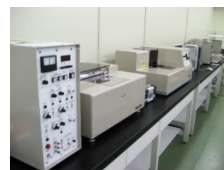
カトーテック製風合い試験機 KES®-FB1-A、KES®-FB2-A など
