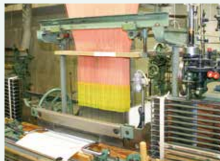
▲ ストーブリ社製電子ジャカードを搭載したシャトル織機
