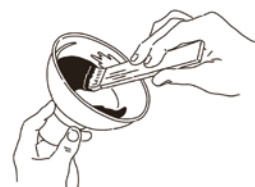
器への漆塗りには、人毛でできた刷毛を使う。塗りムラなくゴミもなく塗りあげるのが職人の技。
