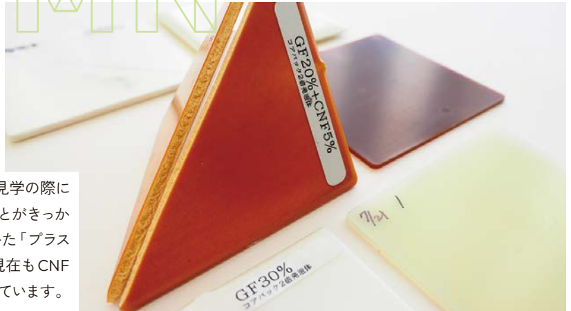
CNFを混ぜたプラスチック（奥：褐色板）を発泡成形した見本
