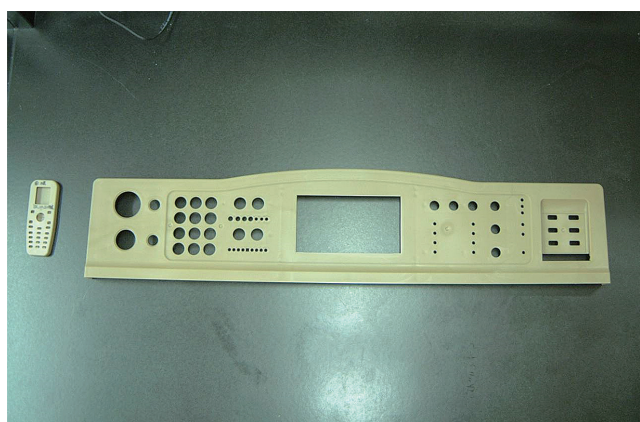
図5 CNF 10 wt% / ポリ乳酸複合材の射出成形製品試作
