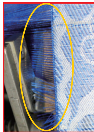
図6 タックイン装置を用いない場合の生地端部分 (○印内)
