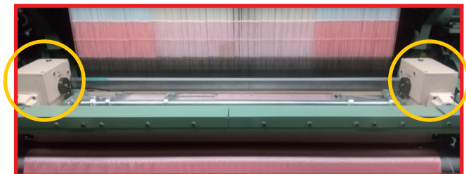
図4 タックイン装置装着後の改造ER広幅レピア織機 (○印内はタックイン装置)
