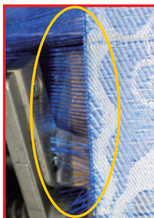
図6 タックイン装置を用いない場合の生地端部分（O印内）
