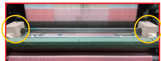
図4 タックイン装置装着後の改造ER広幅レピア織機（O印内はタックイン装置）
