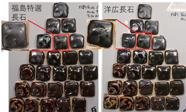
図3 図2の調合にて作製した釉薬テストピース (比較的金色発色の強いポイントを拡大した)
