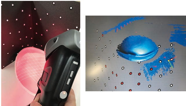
図3 3Dスキャンによるデジタルデータ化
