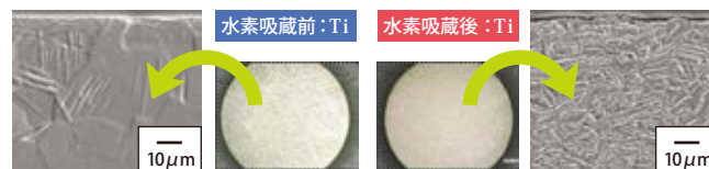
水素吸蔵チタンのマクロ写真とミクロ写真
