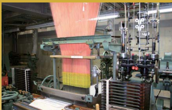
ストーブリ社製電子ジャカードを搭載したシャトル織機
