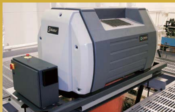
ストーブリ社製電子ジャカード (2688口)
