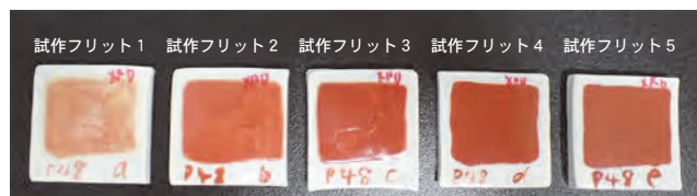
図3 各種試作フリットとT-hematiteから作製した赤絵試片の外観写真
