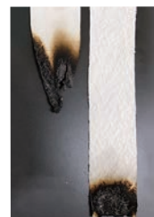
生地燃焼試験 左：防災加工未処理品 右：処理品
