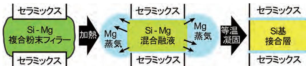
図1 ケイ素 (Si) とマグネシウム (Mg) の複合粉末フィラーを用いたセラミックスの接合
