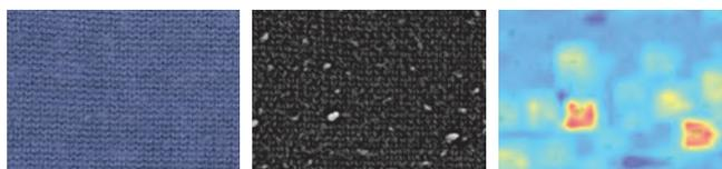
図2（左から）試験片の光学画像、高さを可視化した画像、結果に影響する領域を色分けした画像
