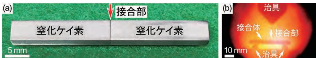
図2 (a) 1100℃で接合した窒化ケイ素接合体の曲げ試験片, (b) 大気中1200℃での3点曲げ試験 (外部機関で実施) の様子
