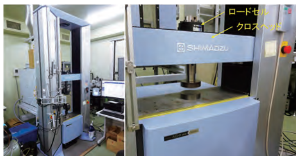
精密万能試験機の外観（左：引張試験、右：圧縮試験）
