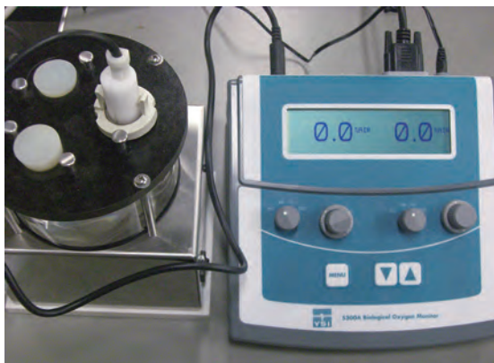
酸素濃度計の外観
