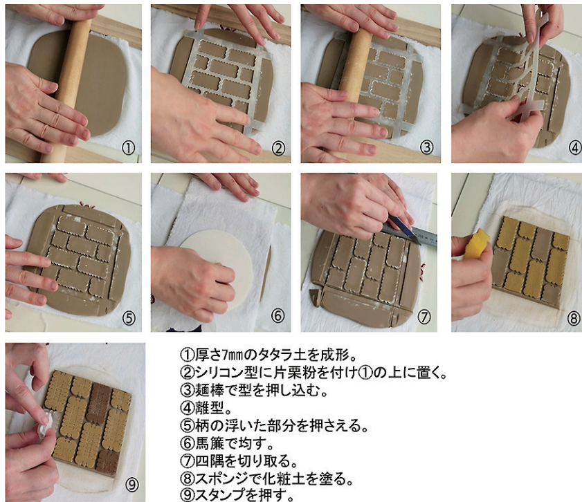
図3 シリコン製型板を使用した新工程での作製テスト
