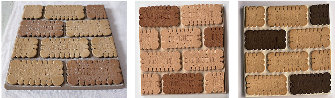
図4 左：図3の成形後の生地 中央：素焼（左右とは別のピース） 右：本焼（左の生地を焼成したもの）
