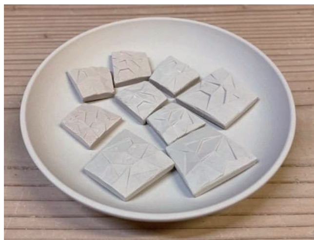
図6 粘土型押し成形・焼成による陶器製試作 (上：石膏押し型 下：陶磁器試作)
