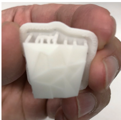
図5 光造形方式3Dプリンタでの原寸大出力
