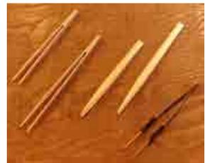
(写真4) ICチップ組立作業用の竹ピンセット
