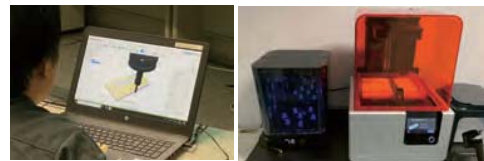
上:講習会の様子。「器」に対しマッピングを実施。 右下:工業部品の加工設定。 左下:光硬化性樹脂3Dプリンタ Form2
