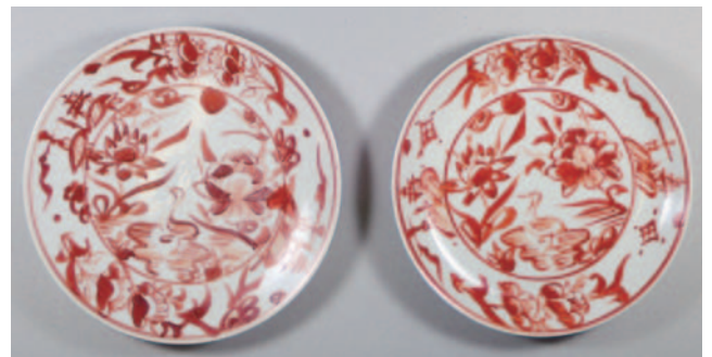
図3 京都産技研フリット及びAFシリーズを用いて作製した赤絵試作品。左：最適化前赤絵具で作製した試作品。右：新製法による赤絵具で作製した試作品
