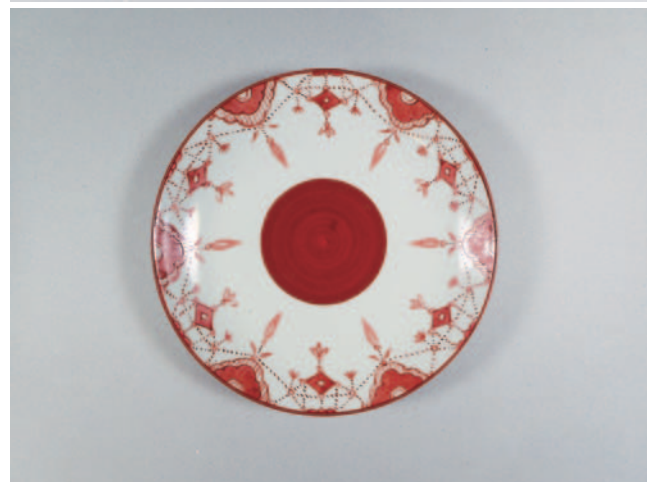
図2 京都産技研フリット及び錦龍ベンガラを用いて作製した赤絵試作品
