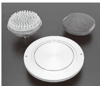
図1 試験機本体(左)と摩擦子(右)
