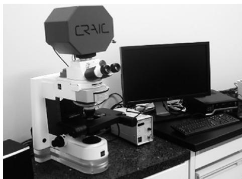
図1 顕微分光光度計の外観
