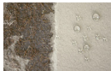
促進耐候試験後のサンプル土壁 （左：未施工、右：パールトーン施工）
