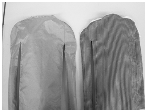
写真3 シームレス立体構造織物
