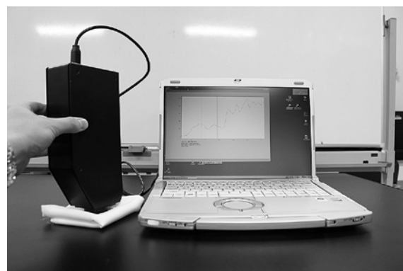
写真1 AOTF型近赤外分光装置
