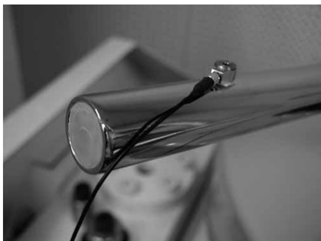
写真4. ハンドル端部とセンサー (内部にシリコンゴムの充填がわかる)
