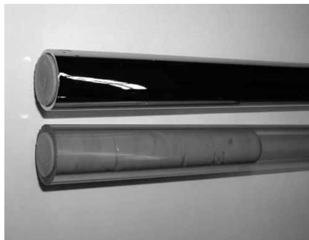
写真5. 充填されたシリコンゴム (上が本物、下は透明パイプで見たもの)
