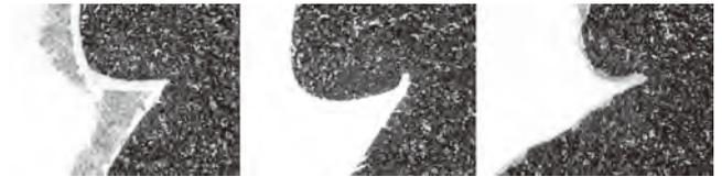
写真2 試験加工による切り口の様子(左：手彫り、中央：カuttingプロッター、右：レーザー加工機)
