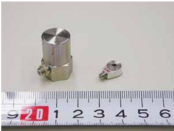
写真4 標準型(左)と小型のセンサー
