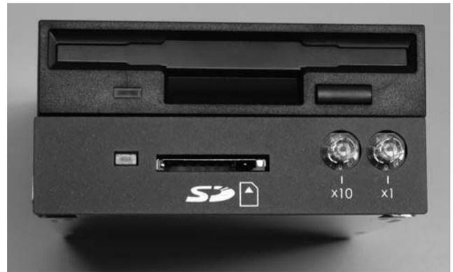
写真3 SDカードを使ったFDD代替装置(下)
