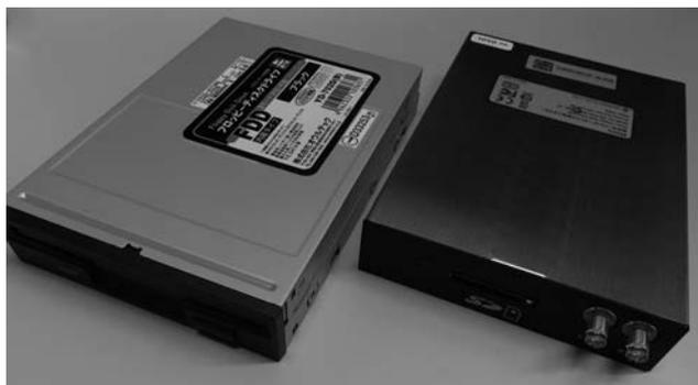
写真2 SDカードを使ったFDD代替装置(右)
