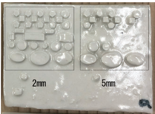
図8 テストピース上の装飾模様の配置 左：型板 2mm厚, 右：型板 5mm厚
