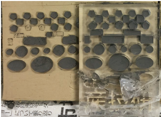
図6 型板で装飾模様を作製する様子 本体：磁土A 装飾模様：磁土A1
