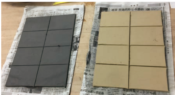
図5 たたら成形で作成した素地本体(磁土の板) 左：磁土A1, 右：磁土A
