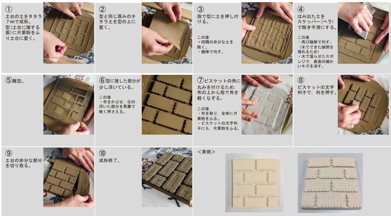
図12 型板を用いた装飾模様 (ビスケットのモチーフ) の成形工程
