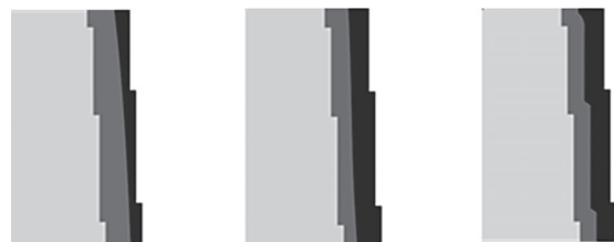
図7 誤差の許容量によるベクターデータの変化 左:許容量 2.5 \text{ px} , 中:許容量 1.5 \text{ px} , 右:許容量 0.5 \text{ px}
