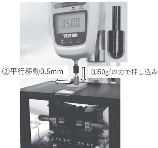
図 10 半球形の接触子と測定の様子
