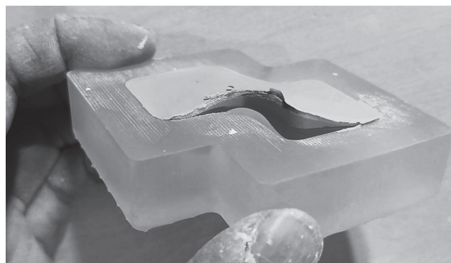
図6 3Dプリントの押型によるテスト
