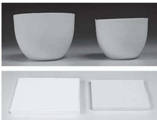
図2. 鑄込み成形により得られた成形体及び焼成体
