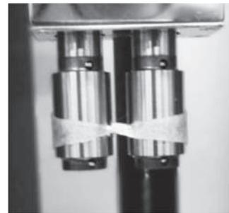
図1 伸長粘度測定用ジオメトリと測定後のサンプル
